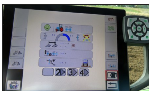
Middels de ISOBus is de ploeg is op de terminal af te stellen
