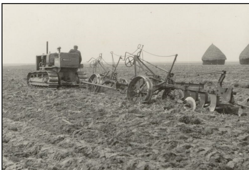
Caterpillar rupstrekker met twee 4-schaar Rud Sack EO 25 ploegen in de Noordoostpolder van de directie Wieringermeer.
