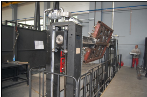
Opnamen in de fonkelnieuwe fabriek, met een nieuwe lasersnijmachine en een mal waarin frames tot 4 bij 6 meter kunnen worden gelast.
