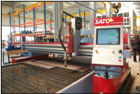
Opnamen in de fonkelnieuwe fabriek, met een nieuwe lasersnijmachine en een mal waarin frames tot 4 bij 6 meter kunnen worden gelast.
