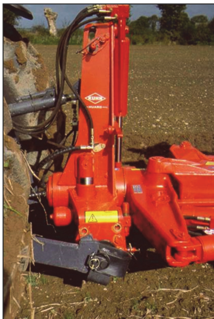
De Vari-Master 183 is standaard voorzien van het unieke Opti-Drive veersysteem
