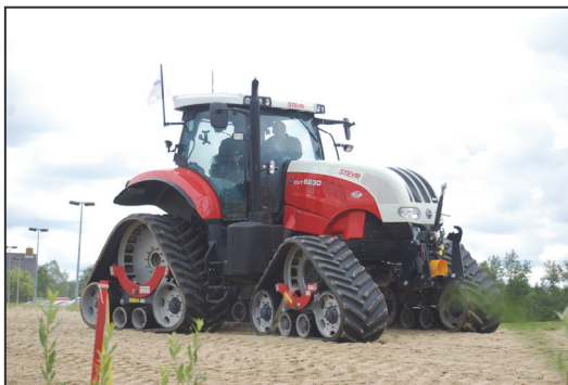
Steyr CVT 6230 rondom op Zuidberg tracs, deze zijn uitwisselbaar met wielen
